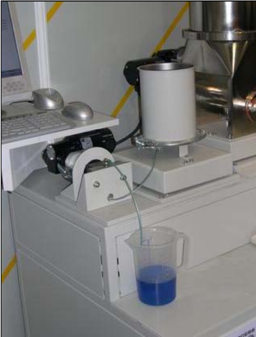
Gravimetrische Flüssigdosierung der Serie LF. Hier gezeigt: Flüssigdosierung in Laborgröße mittels Zahnradpumpe
