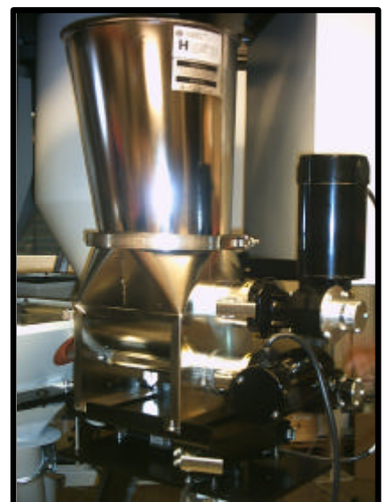
PF Serie Pulverdosierer als Element eines gravimetrischen Mischers
