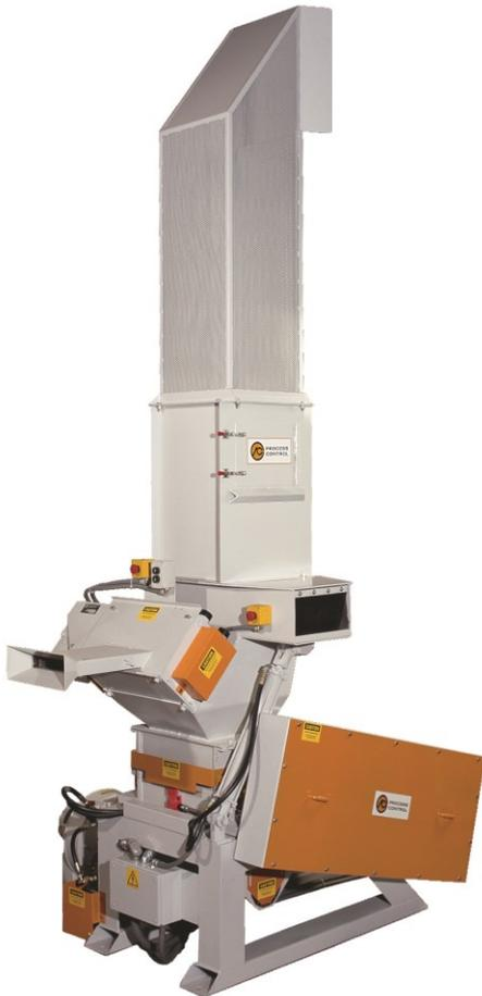
**Die GF-Serie: Folienschneidmühle, Teil eines asr®-Systems, zum Recyclen von Randstreifen, Rollenabfall und losem Abfall. (Abgebildet ist ein GFC30 mit Rollenzuführung, Hydrauliklift zum Öffnen der Mühle und einem AEN Luftabscheider optional.**
