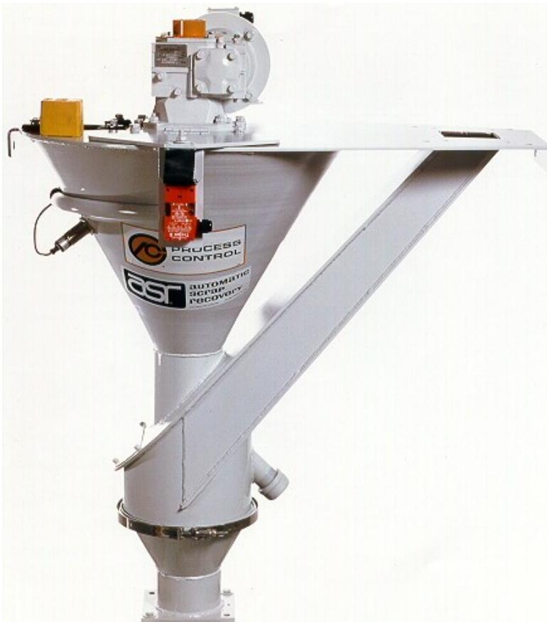
**Die RMX-Serie zum Einsatz in asr® und Gravitrol® Systemen zum Inline-Recycling von Rand- und / oder Konfektionierungsstreifen, Bändchen oder lose Folien, individuell oder synchron**
