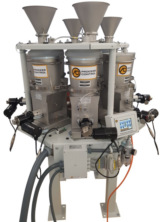
Mehrere MF-Dosierer installiert auf einem kontinuierlichen Mischer
